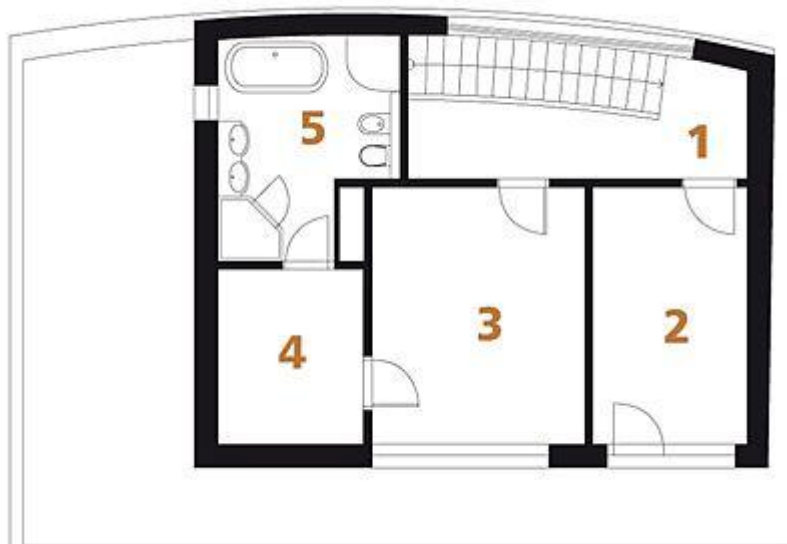
Půdorys patra: 1) hala 2, 3) ložnice 4) šatna 5) koupelna + WC
